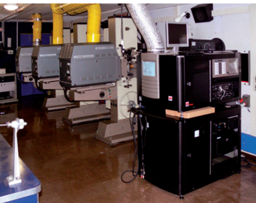
Cabine du Grand auditorium Lumière du palais des Festivals de Cannes équipée d'un projecteur numérique et de trois projecteurs film 35/70mm.
